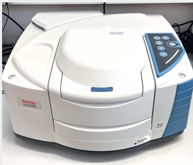
FT-IR spektrometr k měření infračervených spekter používaných k identifikaci (nejen) polysacharidů
