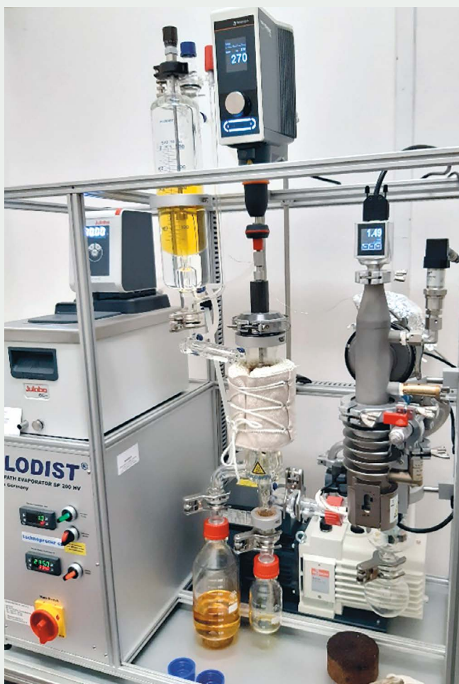
Filmová odparka FilmDist SP 200 HT (Pilodist GmbH, Germany) pro širokou škálu technologických aplikací, zejména odkyselování olejů a tuků, deodoraci, destilaci FAME, separaci mono- a diacylglycerolů, izolaci přírodních látek a simulaci průmyslových technologických experimentů v závěrečné fázi rafinace olejů a tuků
