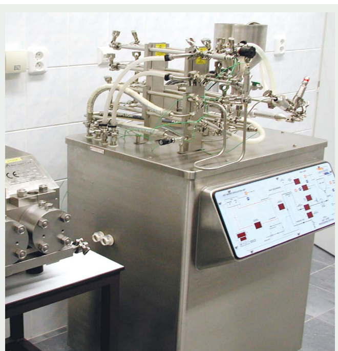
UHT/HTS jednotka FT74 (Armfield, UK) s homogenizátorem Panda 2K (GEA, Niro Soavi, Itálie) pro kontinuální tepelné ošetření a homogenizaci tekutých potravin
